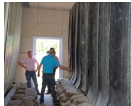
Dans les entrailles du Cynétir - les bandes en caoutchouc évitent les retours de particules provoquées par certaines munitions.
